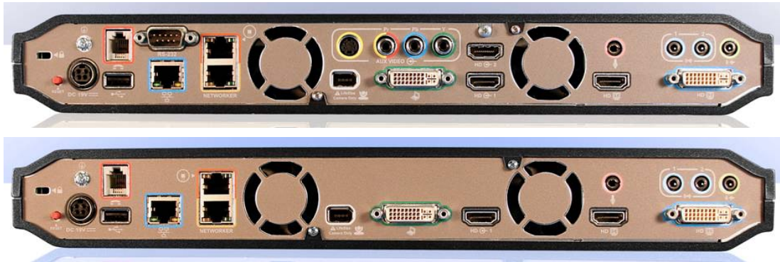
Panneaux arrières du LifeSize Room 200 (dessus) et Team 200 (dessous)
